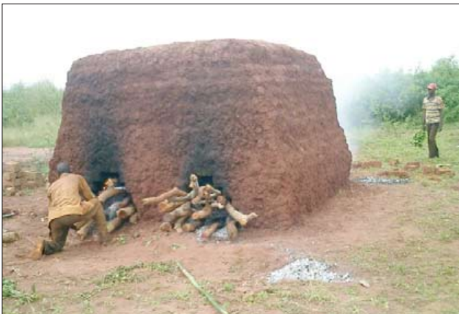
Neuer Ofen brennt die Backsteine, damit sie fest werden
