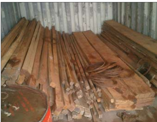
Poutres et poteaux en bois pour le toit, les portes et fenêtres. Fer pour les fondations. Tôle pour le toit.
